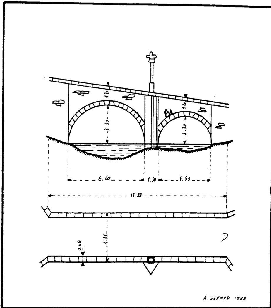
Plan et élévation amont du pont de
